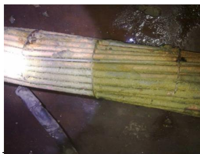
左图为液压站管式冷却器内部管道被原水乙二醇液液侵蚀乳化，导致无法热交换的照片
